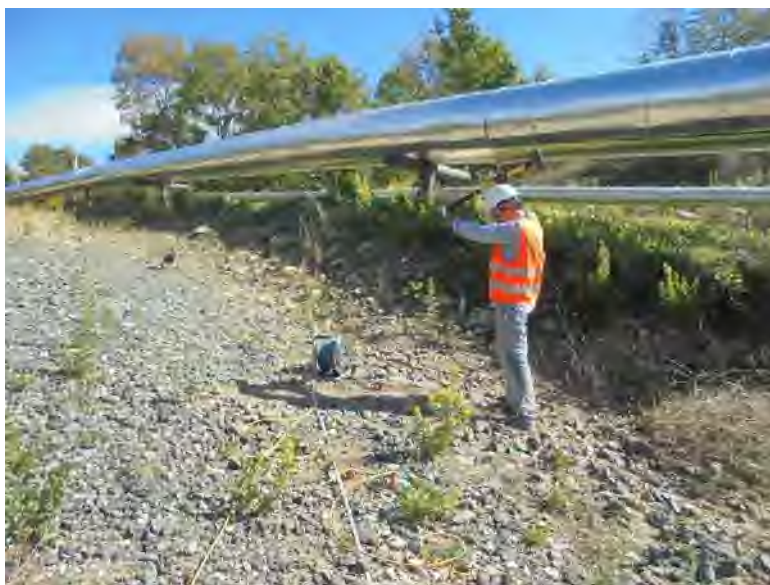
Fig. 7.5 – Frana vapordotto San Paolo. Larderello (PI). Foto del profilo sismico a rifrazione SRT1.
