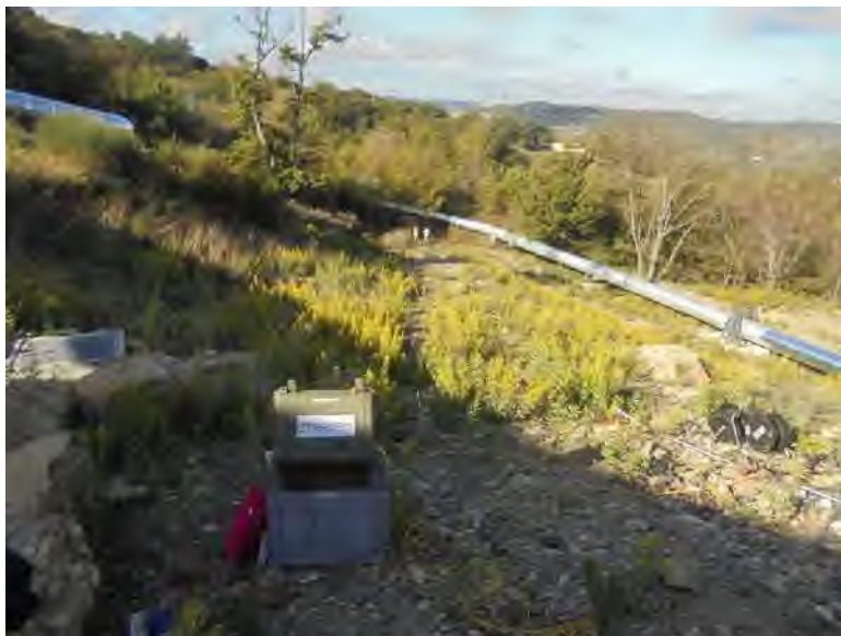
Fig. 7.4 – Frana vapordotto San Paolo. Larderello (PI). Foto del profilo sismico a rifrazione SRT1.
