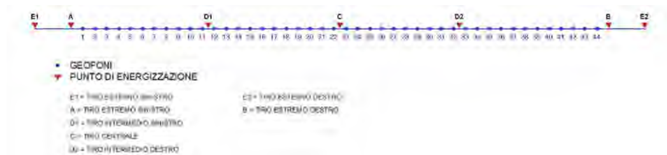
Fig. 7.2 – Tomografia sismica. Disposizione dei siti di energizzazione.
